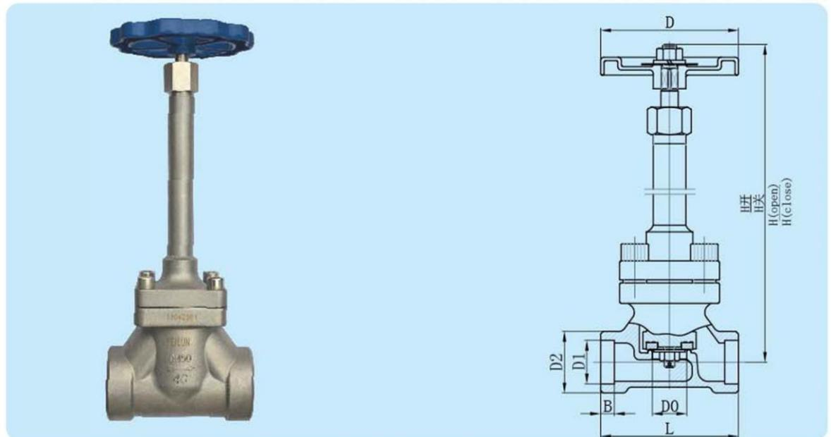
Криогенный запорный проходной сальниковый клапан серии DJ-D относится к стандартным криогенным вентилям со средней длиной штока. Полностью выполнен из нержавеющей стали, в отличие от стандартного исполнения DJ-A. Штоковая группа фиксируется фланцем, а не латунной гайкой. Конструктивные особенности и используемые материалы увеличивают срок эксплуатации клапана и его надежность при высоких нагрузках. Обезжирен для работы с кислородом.
