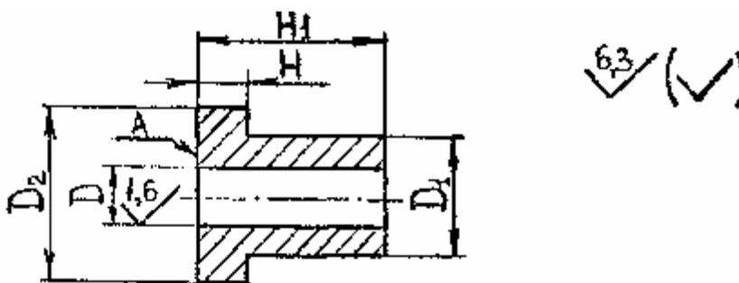
Примечание – Допуск перпендикулярности поверхности А относительно оси отверстия – по 10 степени точности ГОСТ 24643.
