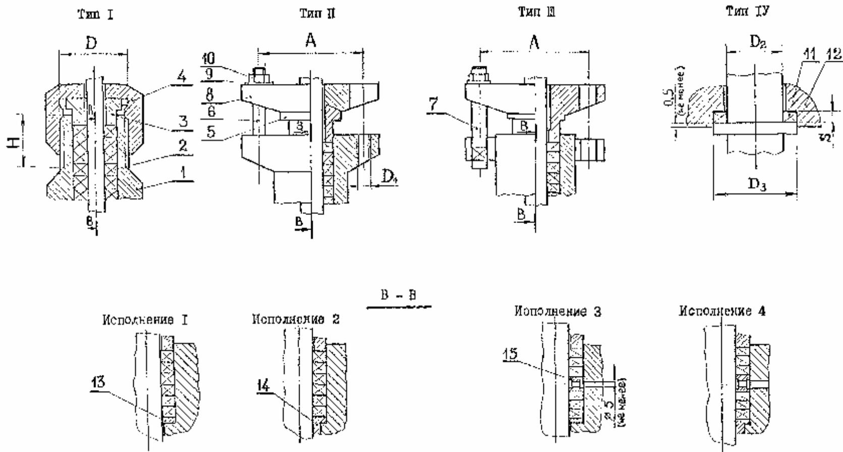
1 – камера сальниковая, 2 – кольцо сальниковое, 3 – втулка сальниковая, 4 – гайка накладная, 5 – втулка, 6 – крепеж (шпилька по ГОСТ 22032, болт откидной по ГОСТ 3033), 7 – болт анкерный по ГОСТ 7802, 8 – фланец нажимной, 9 – шайба по ГОСТ 11371, 10 – гайка по ГОСТ 5915, 11 – прокладка, 12 – корпус, 13 – кольцо поднабивочное, 14 – втулка поднабивочная, 15 – втулка промежуточная.
