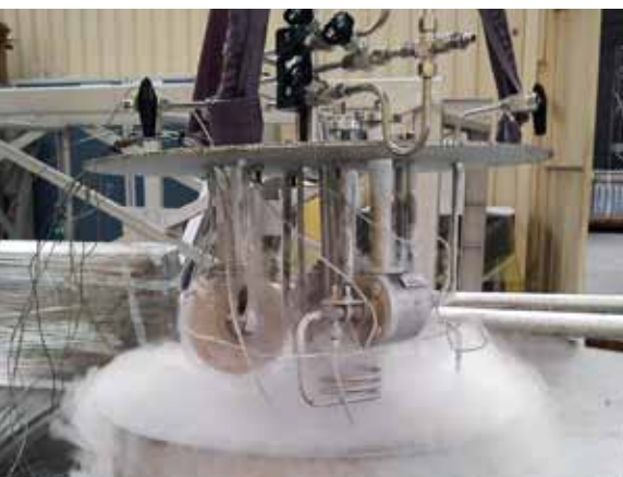
Тестирование герметичности на предельно низких температурах
