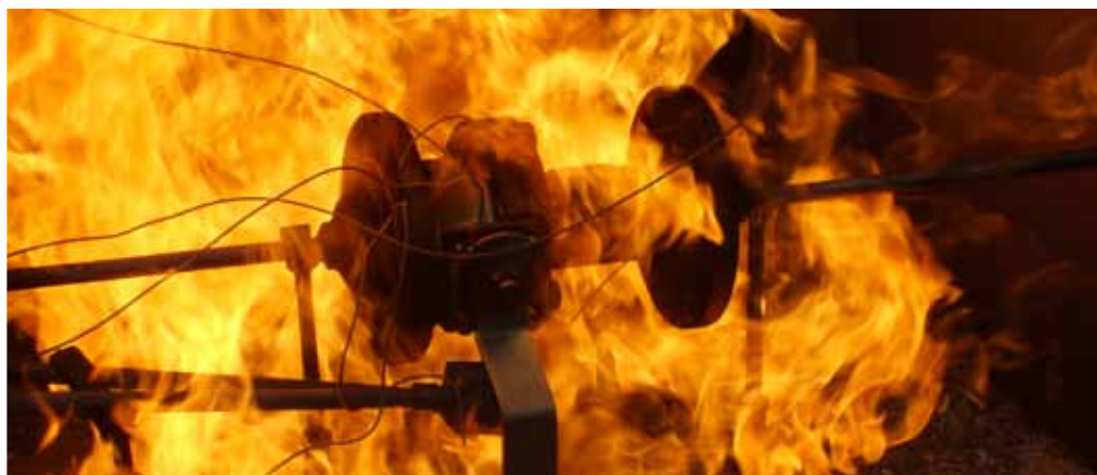
Квалификация «Огнестойкий» в соответствии с нормой EN ISO 10497
