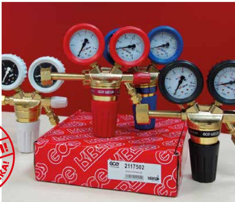
Регуляторы давления и редукторы баллонные одноступенчатые BASE CONTROL предназначены для понижения и регулирования давления газа, поступающего из баллона, и автоматического поддержания постоянным заданного рабочего давления газа при питании постов и установок газовой сварки, резки, пайки, нагрева и других процессов газопламенной обработки.
