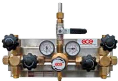
Ручной переключающий манифольд для различных газов с входным давлением до 300 бар. С обеих сторон на входе находится х-образный блок с обратными вентилями и фильтрами, продувочными вентилями и вторыми локальными входными патрубками для расширительных блоков. Отсечные вентиляы, регулятор с вентилем сброса давления и выпускным шаровым вентилем, а также другие компоненты смонтированы на щите из нержавеющей стали.
