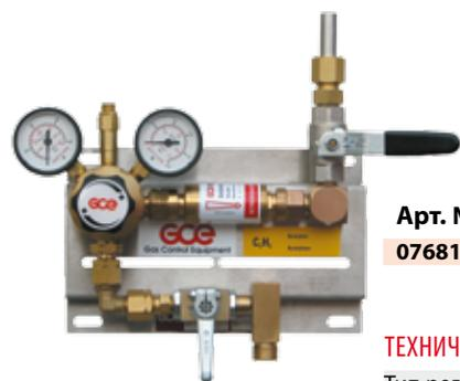
Версия манифольда ММ70-1 для работы с ацетиленовыми баллонами. Разработана и произведена в соответствии с положениями ISO 14 114. Здесь используется ручной быстродействующий отсечной вентиль, расположенный вверх по потоку от регулятора. В состав входит предохранительный затвор GVA 90 (EN 730-1, ISO 5175), расположенный вниз по потоку от регулятора, а также выпускной шаровой вентиль.
