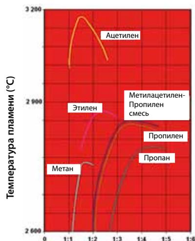
Отношение смеси (топливный газ : кислород)
