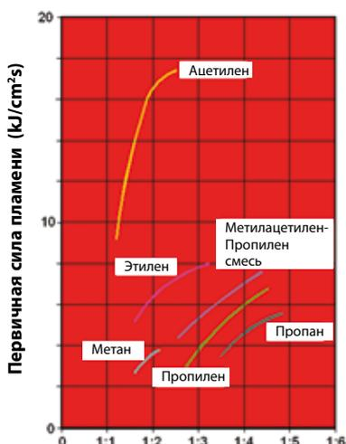
Отношение смеси (топливный газ : кислород)
