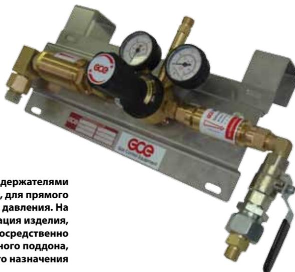
**MU70-M со смонтированными подвесными держателями и выходным патрубком с адаптером, для прямого присоединения шлангов низкого давления. На рисунке показана оптимальная конфигурация изделия, позволяющая размещать MU70-M непосредственно на баллонной связке или раме баллонного поддона, например, для систем локального назначения**
