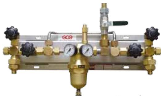
Ручной переключающий манифольд с регуляторами MR60 или MR400 для систем с высокой пропускной способностью различных газов с давлением на входе до 300бар. На обеих сторонах входа находится х-образный блок с обратными вентилями и фильтрами, продувочными вентилями и вторыми локальными входными патрубками для расширительных блоков. Отсечные ventили, регулятор с вентилем сброса давления и выпускным шаровым вентилем, а также другие компоненты смонтированы на щите из нержавеющей стали.
