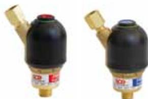
FR50 является предохранительным затвором, обладающим разнообразными функциональными возможностями. В его состав входит обратный клапан, пламепреградитель, затворы, активируемые по температуре и давлению. На газовом входе также предусмотрен фильтр. Он может монтироваться на баллонных регуляторах, а также может использоваться в качестве компонента выпускной арматуры DINSET (смотри на странице 29).
