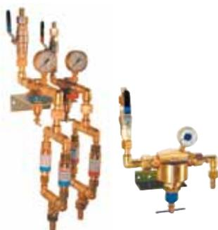
Данная тройная выпускная арматура построена на основе регулятора S200 для режущего кислорода. Нагревательный кислород и топливный газ подаются через регуляторы S100, оба со сдвоенным подключением трехфункционального предохранительного затвора GVO90 и GVA90.
