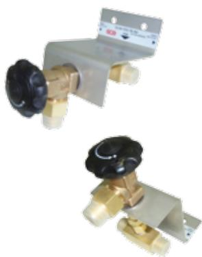
ME-1 включает входной патрубок с отсечным вентиляем, обратный клапан, сборную трубку и два выходных патрубка. Корпуса компонентов изготовлены из латуни. Устойчивый стеновой кронштейн, изготовленный из нержавеющей стали 3мм, используется в качестве основания для монтажа компонентов. ME-1 подготовлен для работы с давлениями до 300 бар.
