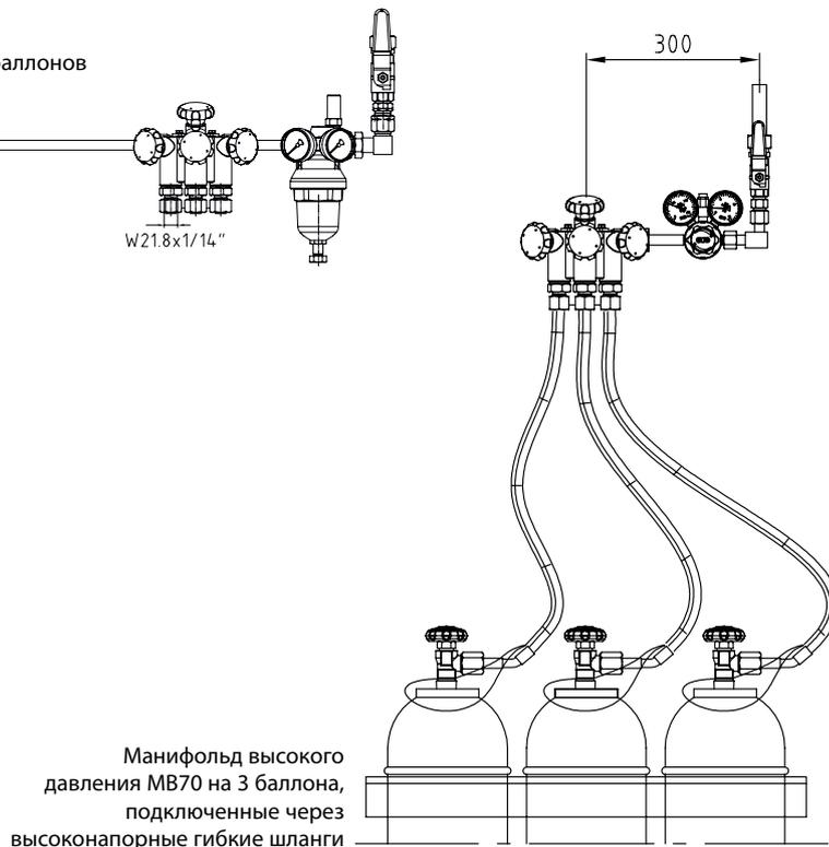
Манифольд высокого давления MB70 на 3 баллона, подключенные через высоконапорные гибкие шланги
