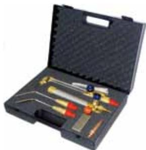
W skład zestawu wchodzi: kasetka plastikowa, rękojeść okrągła, zawory przeciwwrotne BV12, 2 nasadki do spawania, nasadka bezinżektorowa do cięcia z dźwignią, 1 dysza do cięcia 3-50mm, igielki do czyszczenia.
