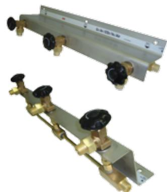
ME-3 включает входные патрубки с отсечными вентилями, обратные клапаны, сборную трубку и два выходных патрубка. Корпуса компонентов изготовлены из латуни. Устойчивый стеновой кронштейн, изготовленный из нержавеющей стали 3мм, используется в качестве основания для монтажа компонентов. ME-3 можно использовать в диапазоне давлений до 300 бар.
