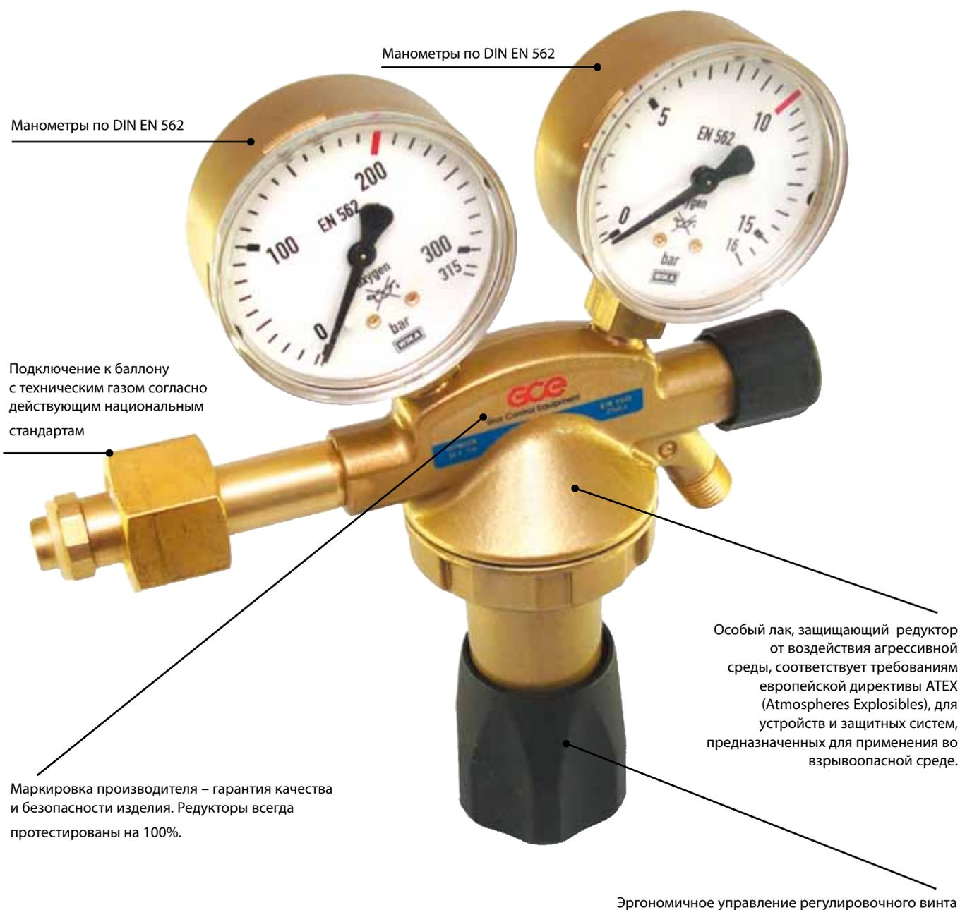
**РЕДУКТОРА ПРЕДНАЗНАЧЕНЫ ДЛЯ РЕГУЛИРОВАНИЯ (ДАВЛЕНИЯ) НЕАГРЕССИВНЫХ ТЕХНИЧЕСКИХ ГАЗОВ, ОТБИРАЕМЫХ ИЗ БАЛЛОНОВ ПОД ДАВЛЕНИЕМ, РАБОТАЮТ С ДАВЛЕНИЕМ НА ВХОДЕ ДО 200 БАРОВ ИЛИ 300 БАРОВ.**
