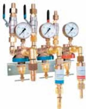
Тройная выпускная арматура с регуляторами S100, смонтированная на прочном стеновом кронштейне. Выходные патрубки для нагревательного кислорода, а также для топливного газа включают трехфункциональный предохранительный затвор GVO90 и GVA90.
