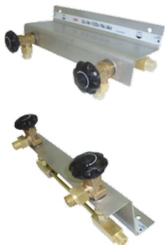
ME-2 включает входные патрубки с отсечными вентилями, обратные клапаны, сборную трубку и два выходных патрубка. Корпуса компонентов изготовлены из латуни. Устойчивый стеновой кронштейн, изготовленный из нержавеющей стали 3мм, используется в качестве основания для монтажа компонентов. ME-2 можно использовать в диапазоне давлений до 300 бар.
