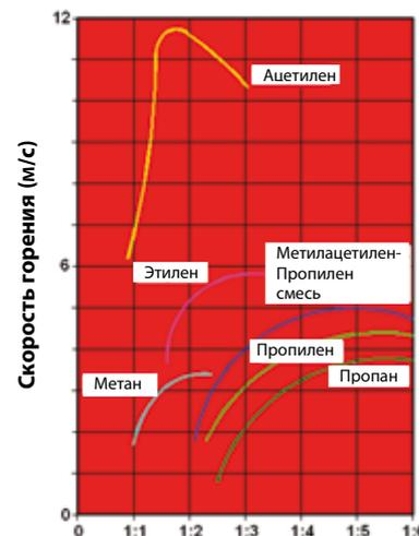
Отношение смеси (топливный газ : кислород)
