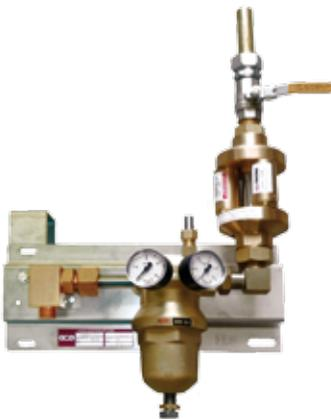
Вариант для пропана оснащен регулятором большой пропускной способности, а также включает предохранительный затвор большой пропускной способности Simax 3 на выходе. Simax 3 представляет собой предохранительный затвор большой пропускной способности в соответствии с требованиями EN 730-1 и ISO 5175 и оснащен фильтром, пламепреградителем, термическим затвором и обратным вентиляем. Также предусмотрена возможность использования подвесного комплекта для мобильных локальных систем.
