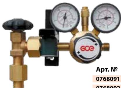
Базовый аппарат с одним входом и одним выходом, отсечным вентиляем и регулятором давления, с входным фильтром и обратным вентиляем. Предназначен для систем малого или среднего расхода газа и рассчитан на работу с одним баллоном или баллонной связкой.
