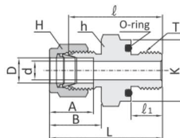
Соединение дюймовых трубок с внутренней цилиндрической резьбой
