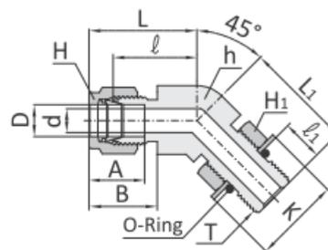
Соединение дюймовых трубок с внутренней цилиндрической резьбой SAE / MS
