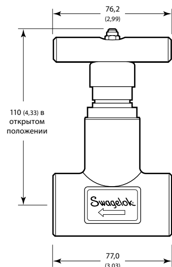
Прямая конфигурация, внутренняя резьба NPT 1/2 дюйма на входе и выходе
