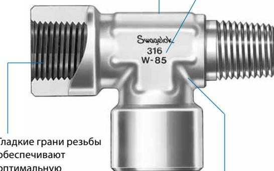
Гладкие грани резьбы обеспечивают оптимальную герметизацию и минимизируют заедание.
