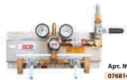
Версия ручного переключающего манифольда MM70-2 для работы с ацетиленовыми баллонами. Разработана и произведена в соответствии с положениями ISO 14 114. На каждой стороне на входе вверх по потоку от регулятора используются ручные быстродействующие отсечные вентиляы. Данные устройства прошли испытания в соответствии с положениями ISO 15 615. В состав входит предохранительный затвор GVA 90 (EN 730-1, ISO 5175), расположенный вниз по потоку от регулятора, а также выпускной шаровой вентиль.
