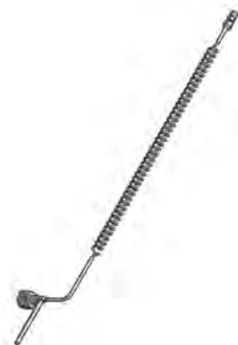
В соответствии с DIN 477/ 230 бар, трубка диам.1/8", с шестигранной гайкой, выход NPT ¼"m. Материал нержавеющей сталь/ ПТФХЭ. Соединения для баллонов согласно другим стандартам, в частности, AFNOR, NEN, ... по запросу.
