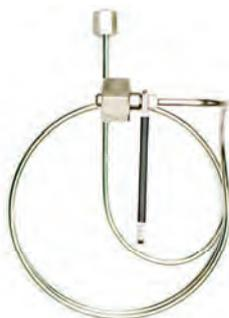
В соответствии с DIN 477/ 230 бар, с шестигранной гайкой, трубчатый змеевик диам. 6 мм. Материал: нерж. сталь/ ПТФХЭ. Выход, накидная гайка M14 × 14,5 или NPT 1/4"m. Пигтейловая трубка позволяет соединить панель для управления подачей газа с источником газа в ограниченном пространстве. Встроенные ручки обеспечивают беспотенциальные и газонепроницаемые соединения. Соединения для баллонов согласно другим стандартам, в частности, AFNOR, NEN, ... или баллоны на 300 бар по запросу.
