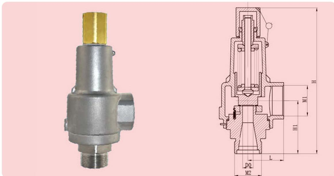
Криогенный предохранительный клапан модели DAN имеют более сложную конструкцию по сравнению с DA-08, что несет увеличение цены, но и большую надежность, уровень герметичности. Давление настраивается на заводе-производителе и не может быть перенастроено пользователем. Не имеет ручного подрыва, обезжирен для работы с кислородом.
