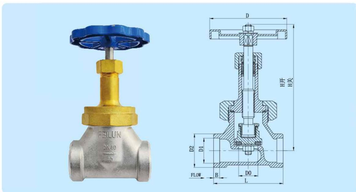
Криогенный запорный проходной сальниковый клапан серии DJ-B относится к стандартным криогенным вентилям с коротким штоком. Используется при ограничении в пространстве при монтаже изделия и кратковременной работе с криогенными жидкостями. Обезжирен для работы с кислородом.
