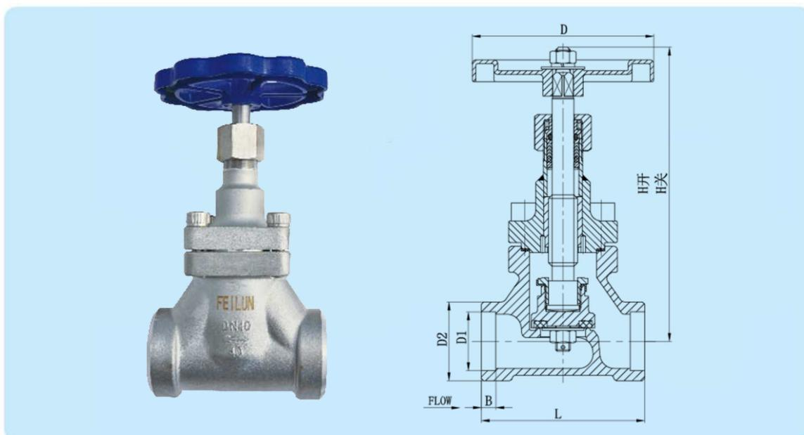
Криогенный запорный проходной сальниковый клапан серии DJ-GY относится к стандартным криогенным вентилям с коротким штоком. В отличие от DJ-G он имеет иной размер присоединения под приварку дюймовой трубы внахлест и длину штока. Используется при ограниченном пространстве для монтажа изделия и кратковременной работе с криогенными жидкостями. Обезжирен для работы с кислородом.
