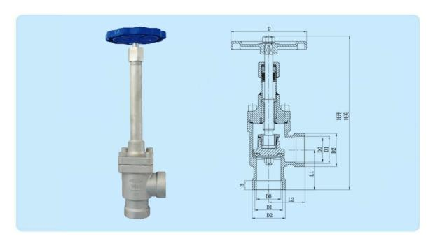
Криогенный запорный угловой сальниковый клапан серии DJZ относится к стандартным криогенным вентилям с увеличенной длиной штока. Используется при ограничении в пространстве при монтаже изделия. В отличие от других серий, данный клапан оснащен фланцевым креплением крышки корпуса. Обезжирен для работы с кислородом.
