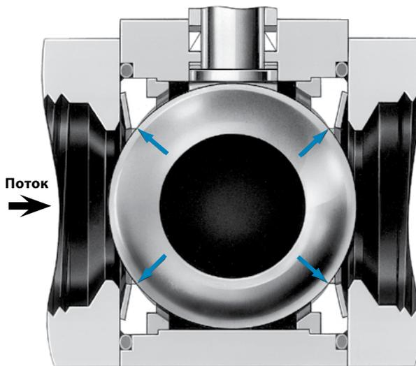
При высоком давлении шар вытесняется в направлении выходного отверстия давя на седло, и создавая уплотнение. Седло у входного отверстия при движении шара также изгибается, и поддерживает уплотнение.
