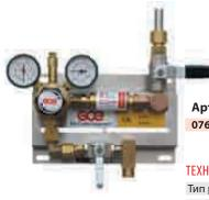
Версия манифольда ММ70-1 для работы с ацетиленовыми баллонами. Разработана и произведена в соответствии с положениями ISO 14 114. Здесь используется ручной быстродействующий отсечной вентиль, расположенный вверх по потоку от регулятора. В состав входит предохранительный затвор GVA 90 (EN 730-1, ISO 5175), расположенный вниз по потоку от регулятора, а также выпускной шаровой вентиль.
