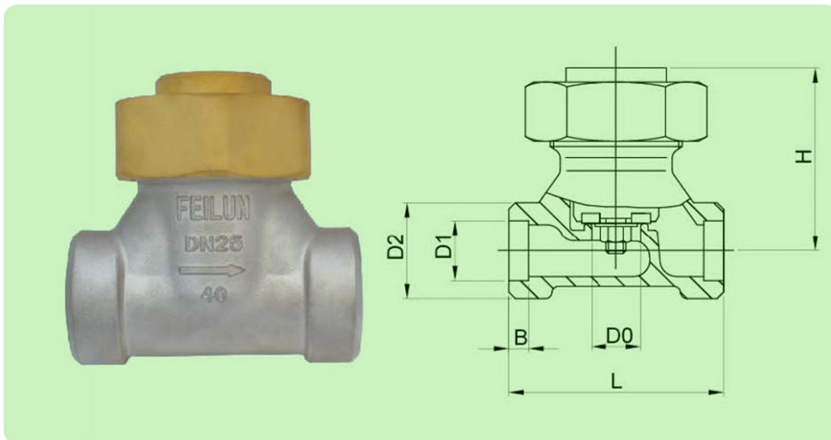
Подъемный проходной криогенный обратный клапан серии DH является самым популярным типом обратных клапанов в линейке Feilun. Данное изделие используется для газификаторов, криогенных емкостей и стационарных трубопроводов. Функция обратного клапана: свободное пропускание рабочей среды в одном направлении и препятствие обратному ходу рабочей среды. Сменное уплотнение PCTFE обеспечивает высокую ремонтопригодность и герметичность клапана. Обезжирен для работы с кислородом.
