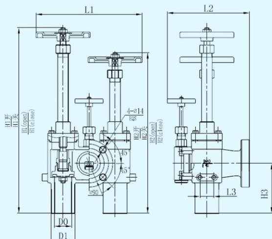
Заправочный узел типа DJC предназначен для непрерывной заправки двух и более криогенных емкостей. Данный узел может быть снабжен обратным клапаном для препятствия разбрызгивания рабочей среды после удаления рукава. Также заправочный узел снабжен сбросным вентилем, для безопасного удаления остатков криогенного продукта из центральной части узла. Все части выполнены из нержавеющей стали. Обезжирен для работы с кислородом.
