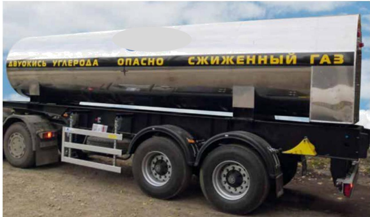
**Полуприцеп-цистерна для транспортировки жидкой двуокиси углерода ЦЖУ-10.**
